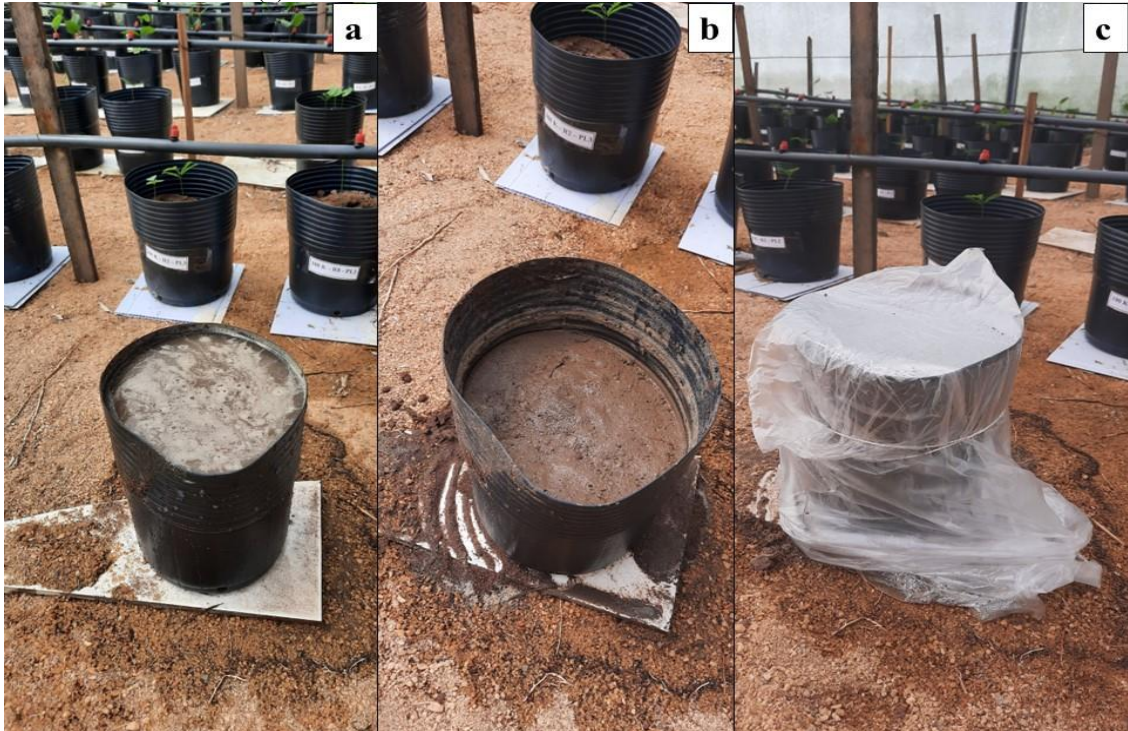
Figura 8- Saturação do solo com água (a), crosta de água na superfície do solo (b) e cobertura do vaso com plástico (c) na UFRA- CCP.
