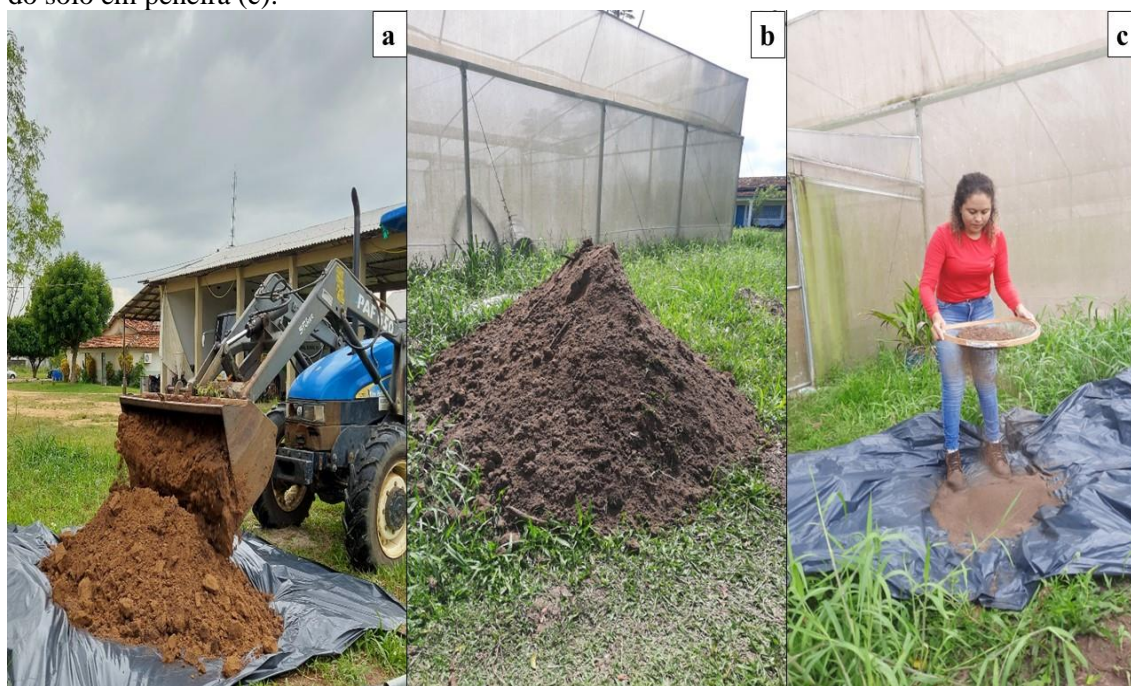
Figura 5- Deposição do solo em uma lona plástica (a), secagem do solo ao ar livre (b) passagem do solo em peneira (c).
