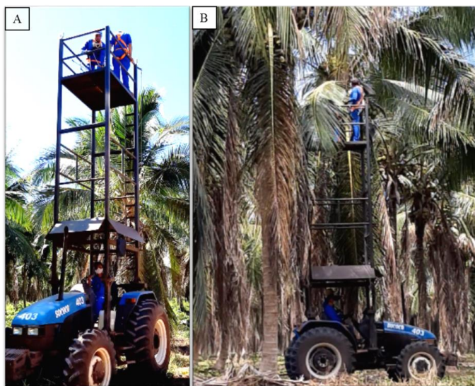
Figura 2. Torre de aplicação acoplada sobre trator (A) para aplicação de tratamentos em cachos de plantas de coqueiro (B) atacados por Aceria guerreronis , no município do Moju-PA, Amazonia Oriental, Brasil.
