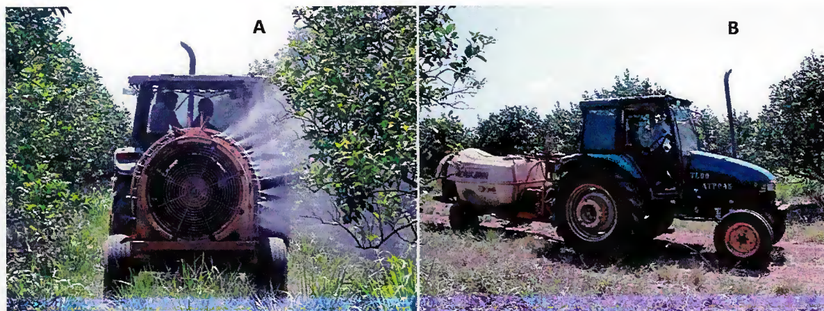
Figura 6. A – Aplicação de imidacloprido em laranjeiras. B – Trator de 90 HP utilizado para transportar o turbo atomizador em pomar de laranja no Município de Capitão Poço - PA no ano de 2010.
