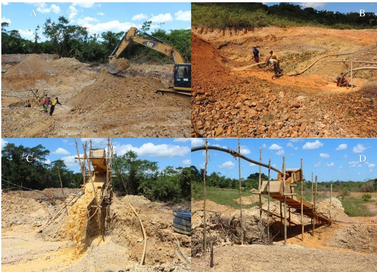
Fotos: Teixeira, R. A. (2018); A – Destruição de morro; B – Jato d’água e Sucção; C – Caixa concentradora; D – Descarte no igarapé do Macaco.
