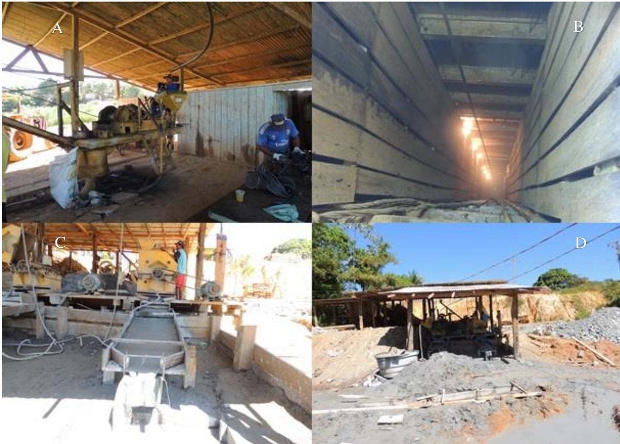
Fotos: Teixeira, R. A. (2018); A - Elevador de carga; B - Fosso 150m; C – Caixa concentradora; D - Rejeito de mina.
