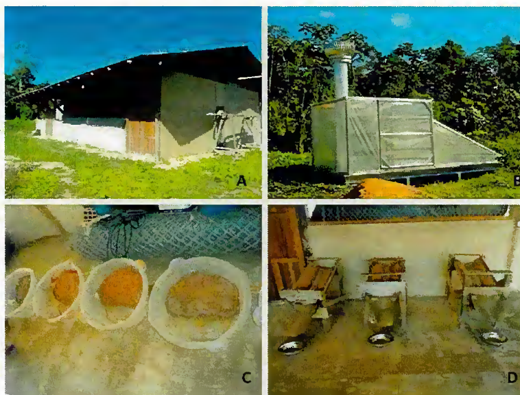
Figura 4: Local de produção e materiais utilizados no processo produtivo do óleo de C. guianensis na comunidade Santo Antônio, Assentamento Moju I e II, Santarém-Pará. (A-barracão para o beneficiamento das sementes, B- secador solar, C- massa em bacias de plástico, D- bicas para decantação do óleo).
