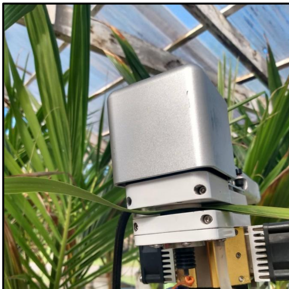
Figura 3. Avaliação das trocas gasosas com auxílio de um analisador de gases infravermelho portátil (IRGA, modelo LI-6400XT, da marca LICOR®).
