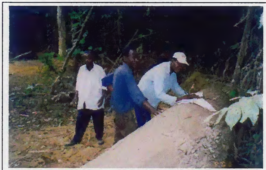
Figura 3b) Atividade de cubagem na área de corte de Pia-Dinge, comuna de Necuto. Os valores das medidas são anotados em um bloco de apontamentos. São mensurados apenas as toras á serem transportadas - 2001
