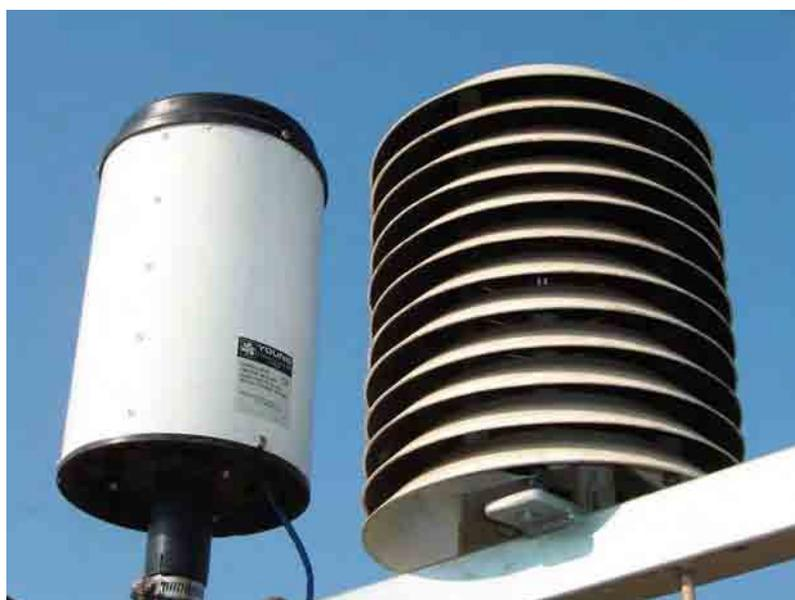
**Figura 19 - Sensores de temperatura e umidade do ar**
