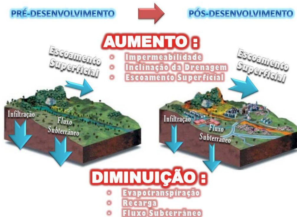
Figura 4 - Mudanças com o desenvolvimento e suas relações com o fluxo hdrológico (Fonte: modificada de PINTO e PINHEIRO, 2006).
