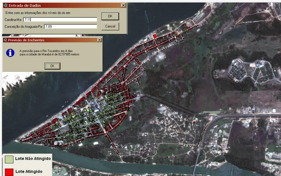
Figura 40 - Resultado da segunda simulação, prevendo uma cota de 82,58 metros.
