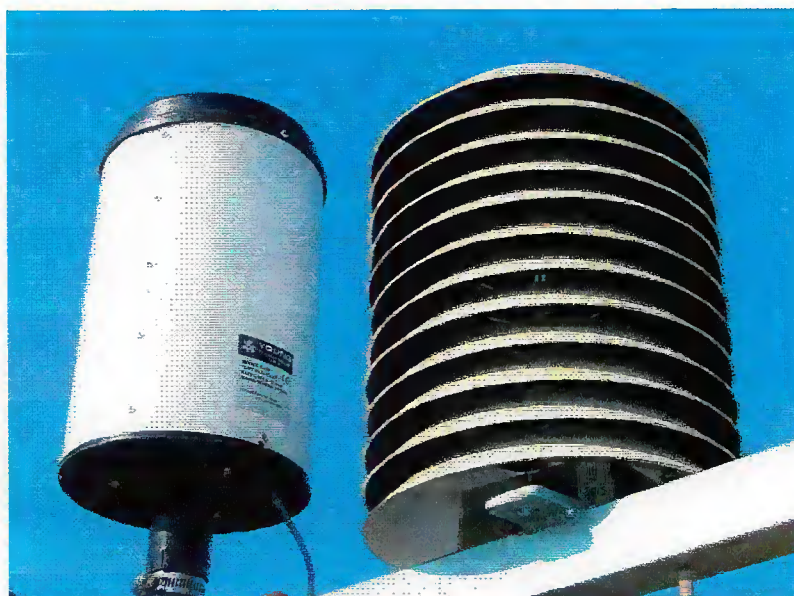
Figura 19 - Sensores de temperatura e umidade do ar
