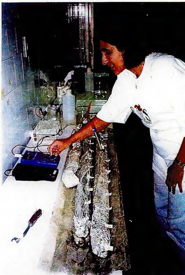
Figura 8: Determinações de pH e eH no solo de mangue
