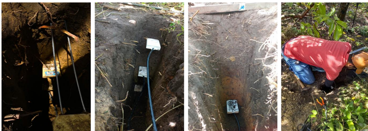
Figura 1.5. Instalação de sensores tipo TDRs em campo para obtenção de dados de conteúdo volumétrico de água no solo.
