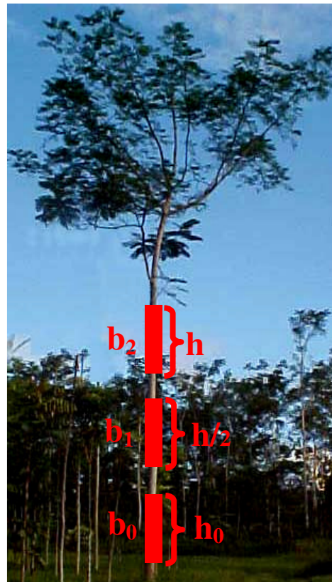
FIGURA 3 - Arranjo ilustrativo de retirada de amostras de madeira no sentido longitudinal do tronco.
