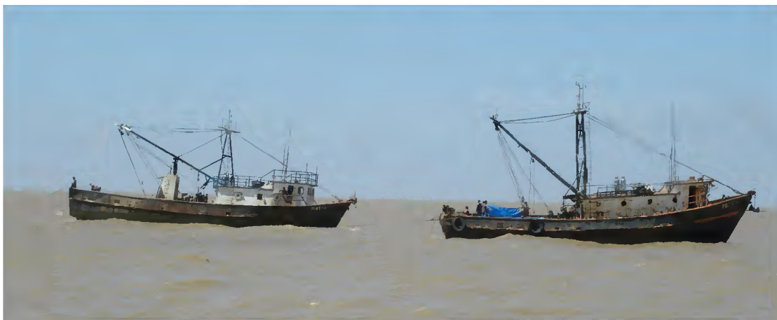
Figura 6. Barcos da frota industrial da piramutaba que atua na foz do rio Amazonas arrastando em “parilha” (Fonte: CEPNOR).
