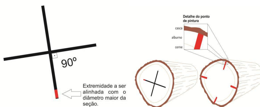
Figura 2 - Ponto de medição dos diâmetros das toras, conforme requerido pelo Serviço Florestal Brasileiro.
