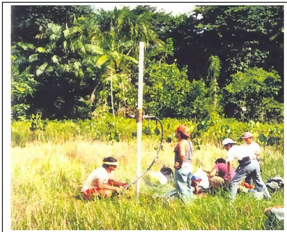
Figura 9. Coleta de testemunho por vibra-core. Fonte: Senna (2002).
