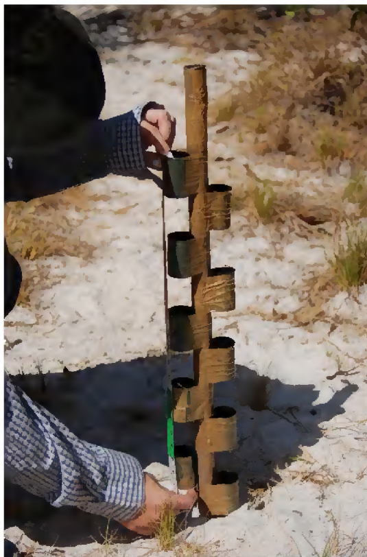
Figura 6: Verificação da inundação. Alcance da maré medido através de fita métrica, baseado no recipiente preenchido com água.
