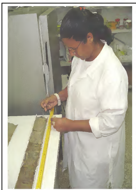
Figura 13. Coleta das amostras sedimentares do testemunho Cajuúna (TC), janeiro/2006.
