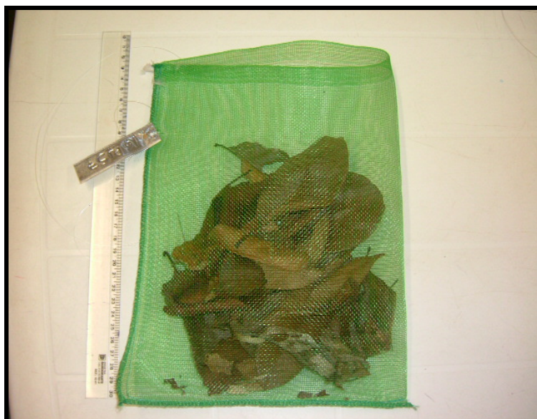
Figura 7: Saco de malha de nylon contendo 10g de folhas secas, com medidas de 20 cm x 30 cm, e malha de 2 mm para permissão da entrada de meso e micro-decompositores.
