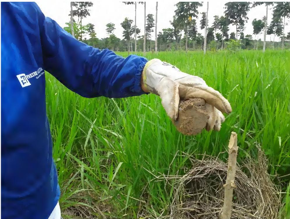
**Figura 41** – Amostra do solo indeformada com a pastagem e as árvores do iLPF ao fundo.
