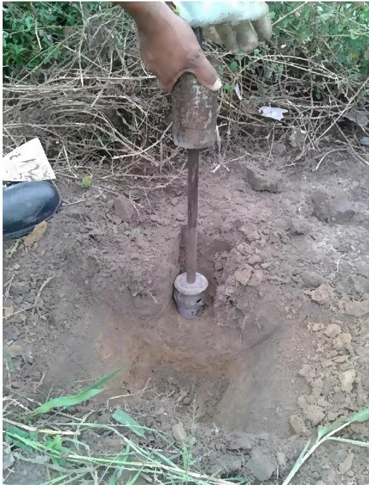
**Figura 35** – Detalhe do amostrador de solo indeformado.
