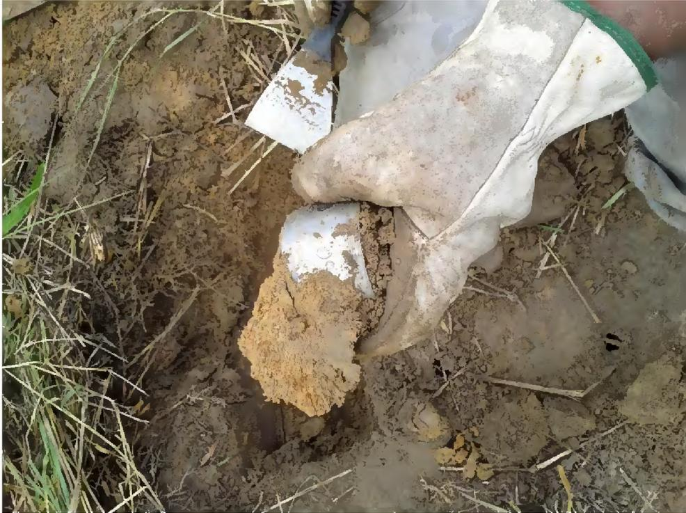
**Figura 42** – Detalhe da limpeza do anel de aço com a amostra indeformada.
