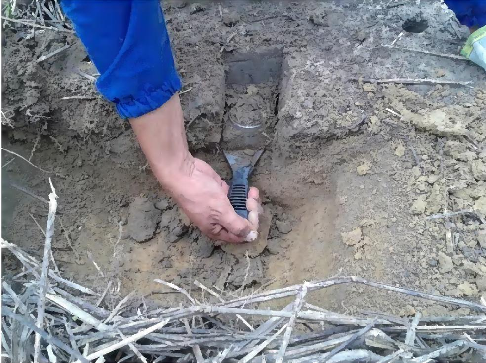
**Figura 38** – Detalhe da remoção da amostra indeformada no perfil do solo.
