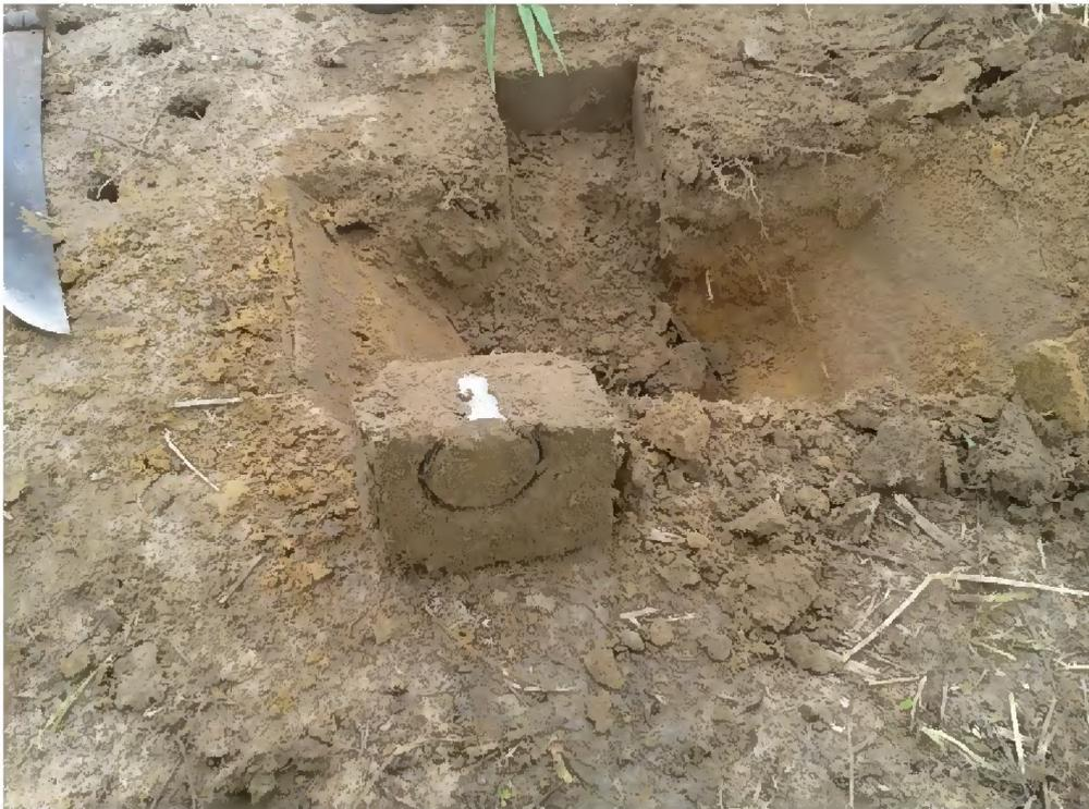
**Figura 39** – Retirada do bloco de solo com o anel de aço da amostra indeformada.
