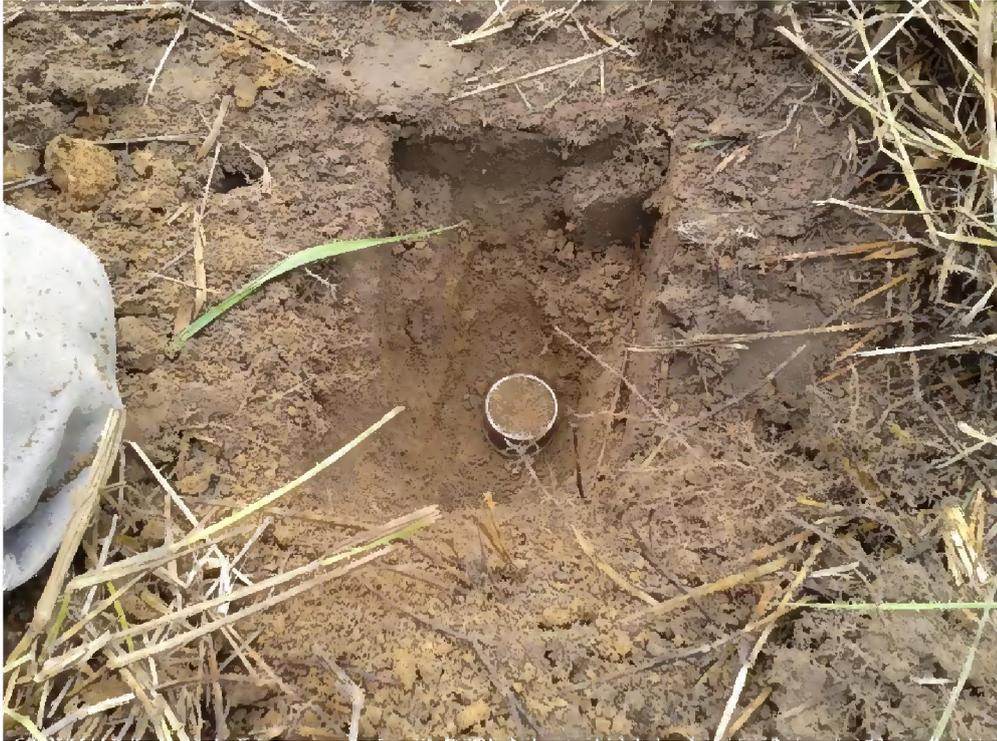
**Figura 36** – Detalhe da amostra de solo indeformada no anel de aço.
