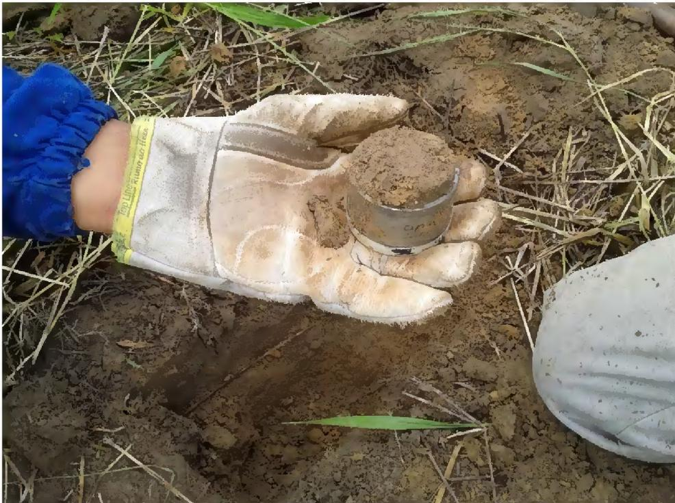
**Figura 43** – Amostra do solo indeformada sendo preparada para armazenamento.
