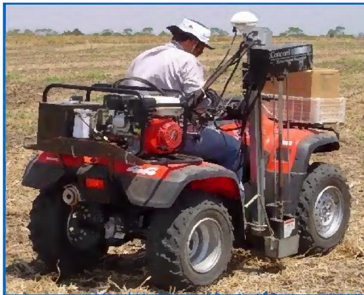
**Figura 3** - Quadriciclo equipado com GPS e amostrador automático de solo.
