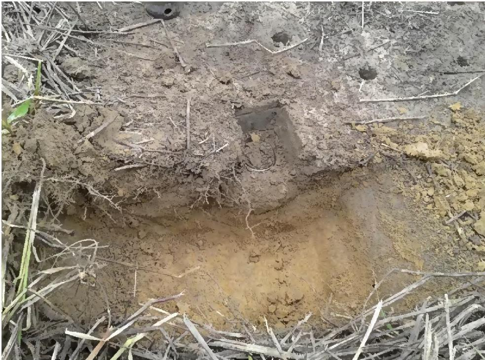
**Figura 37** – Detalhe da extração da amostra do solo indeformada.
