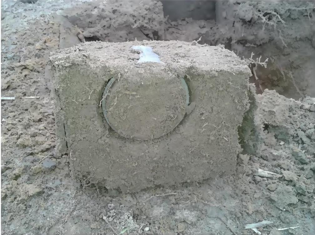
**Figura 40** – Detalhe do bloco de solo com o anel de aço com solo indeformado.
