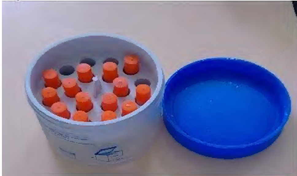
Figura 11. Mister Frost. Aparelho utilizado para o armazenando de criotubo para o congelamento.
