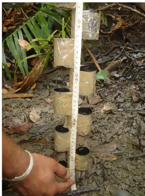
Figura 4: Verificação da inundação. Alcance da maré medido com fita métrica, baseado no recipiente preenchido com água.
