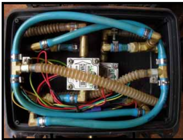
Figura 8. Medidor de consumo horário de combustível utilizado no experimento.
