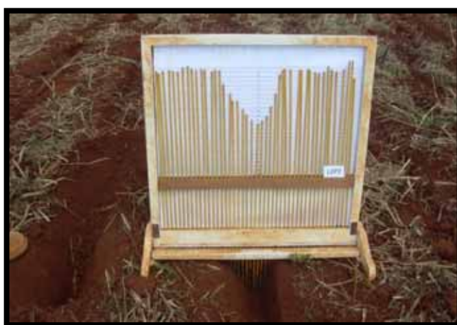
Figura 9. Perfilômetro de varetas para determinação da mobilização do solo.
