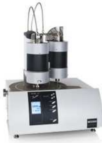
Figura 10 – Equipamento de análise térmica simultânea modelo Netzsch STA 449 F3 Jupiter.
