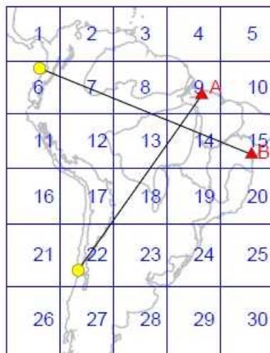
Figura 3.6: Malha para tomografia da América do sul usada por Feng (2004), mostrando como a área de estudo é dividida em células para obtenção da tomografia, bem como o cálculo do tempo de percurso de um evento entre a fonte e a estação. Para o cálculo desse tempo, utiliza-se o percurso dividido pela vagarosidade em cada célula. Mostra também a forma matricial e analítica do funcional utilizado para o cálculo da tomografia.
