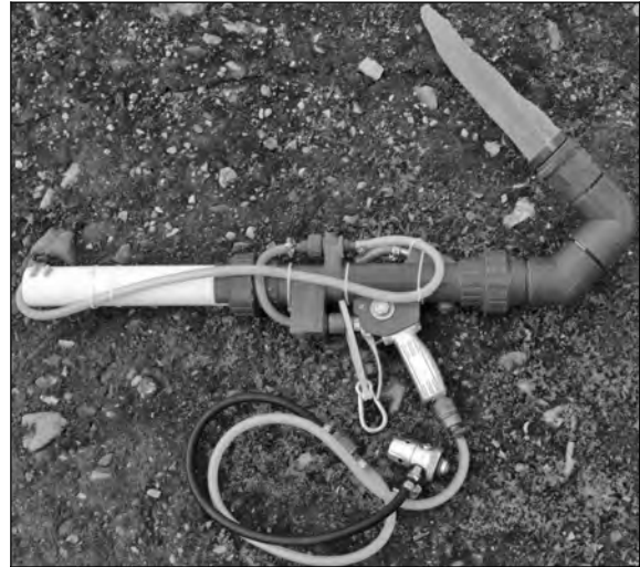
Abb. 4: Airlift System (Länge von 80 cm)
