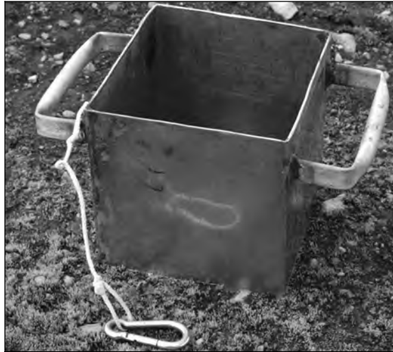
Abb. 3: Stechkasten (Fläche: 0,2 m 2 )
