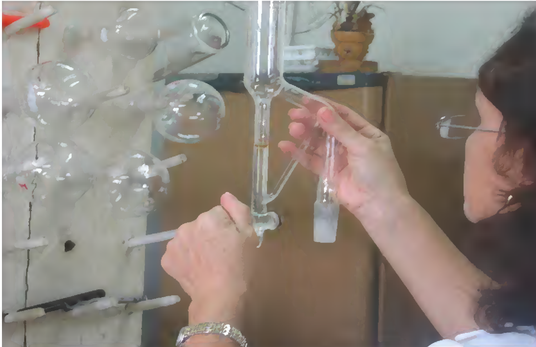
Figura 5b. Separação do óleo e água em destilador Clevenger.
