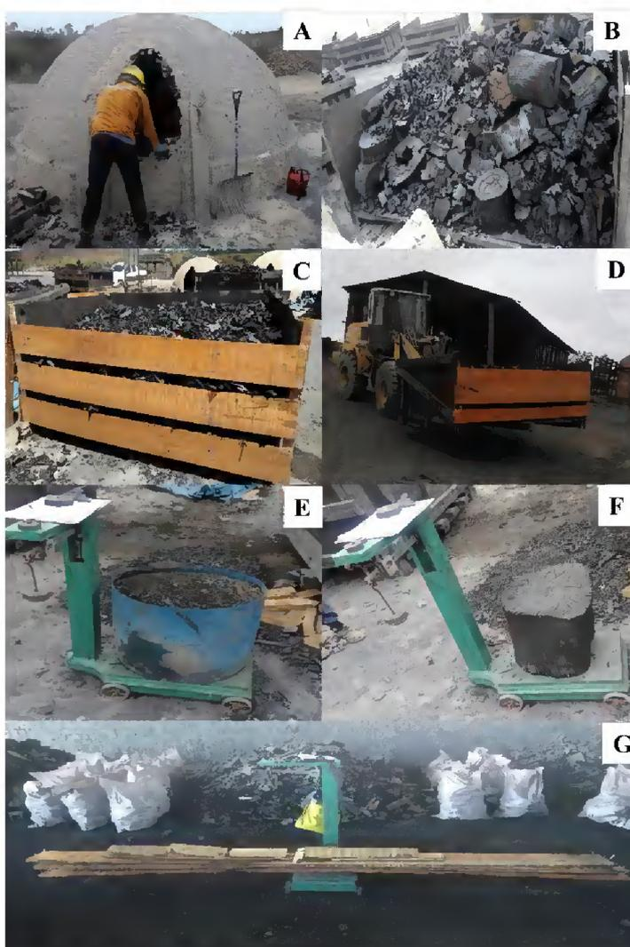
**Fig. 7.** Abertura dos fornos após o ciclo de carbonização de 12 dias (A); enchimento das caixas metálicas com carvão vegetal (B); tábuas de madeira pregadas na região frontal das caixas metálicas (C), carregamento das caixas metálicas com carvão vegetal para pesagem (D), pesagem dos finos (E), tiços (F) e tábuas (G) em balança mecânica.
