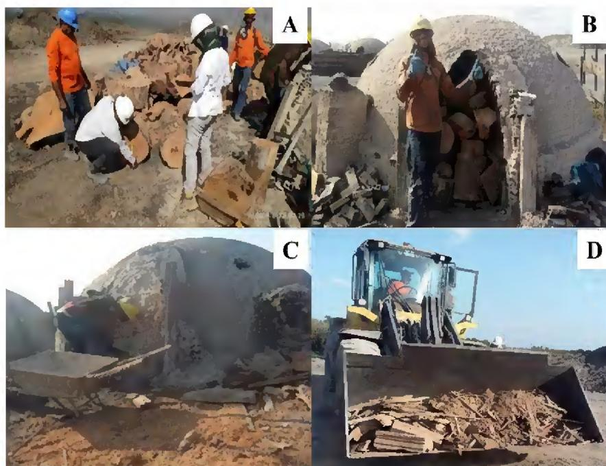
**Fig. 4.** Cubagem rigorosa dos toretes (A), enchimento dos fornos (B), fechamento dos fornos (C) e junção dos toretes e restos de cascas e serragens para pesagem (D).
