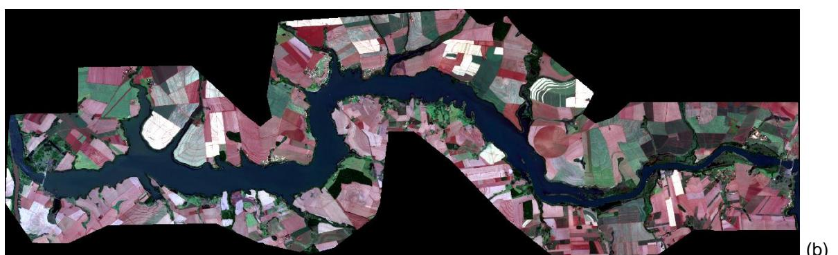
Figura 31. Correção atmosférica, em (a) a Imagem original e em (b) Imagem corrigida atmosféricamente pelo método DOS, ambas imagens do sensor SPOT-6, reservatório de Canoas I, na data de 29/04/2013.
