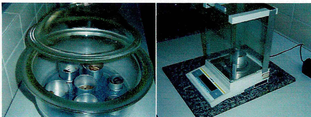
Figura 7. Dessecador e balança analítica utilizada para determinação do grau de umidade.
